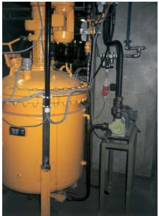
V30-2 ST5WG pump for polyol and isocyanate. Pompe V30-2 ST5WG pour polyol et isocyanate.
